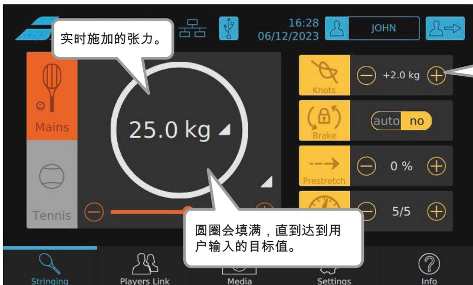
您可以按+ 和 -，调节所需的附加结张力。您可以按图标，以启用/禁用此功能。当框变成带有黄色轮廓的浅灰色时，表明施加了附加张力。此功能在下次拉紧操作后自动禁用。
