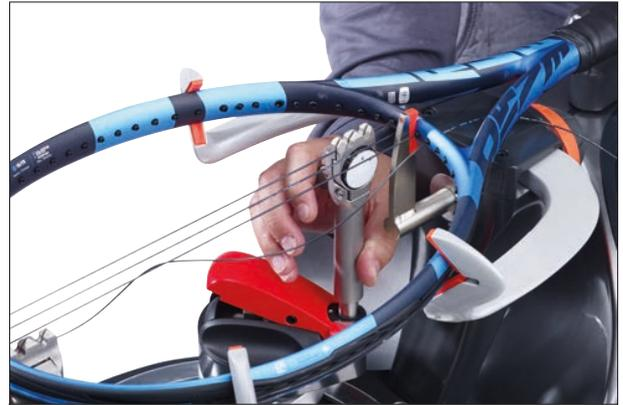
绳线放置在夹爪之间，降低夹杆并在锁杆上施加压力以锁定夹具
