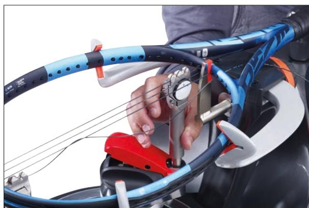
*La cuerda se coloca entre las mordazas de la abrazadera, baje la palanca de la abrazadera y ejerza presión sobre la palanca de bloqueo para bloquear el soporte de la abrazadera.*
