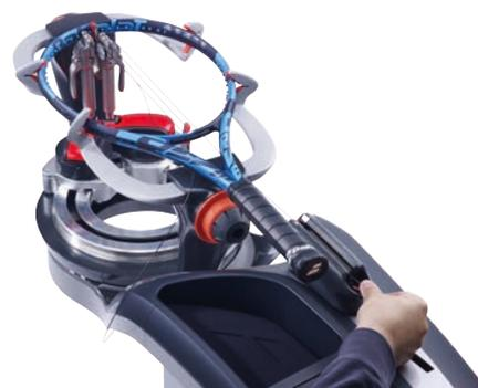
Wenn die gewünschte Spannung erreicht ist, schließen Sie die Zange mit drei Zähnen und blockieren den Spannzangenhalter, um die Saite zu fixieren (siehe Kapitel 5.7 / 5.8). Tippen Sie erneut auf die Zyklusstart-Taste. Der Spannkopf kehrt in seine Ausgangsposition zurück, die selbstschließenden Backen öffnen sich und geben die Saite frei.
