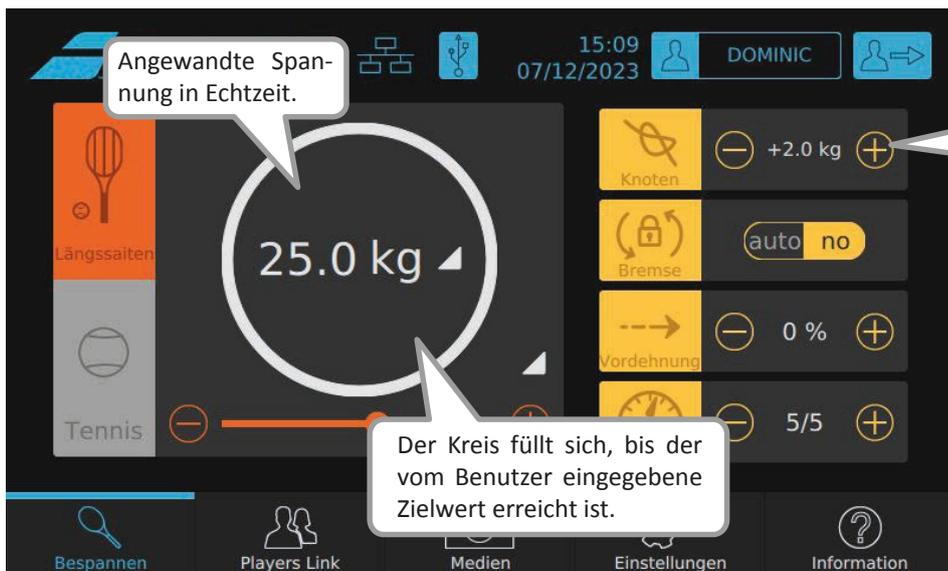
Sie können die gewünschte Knotenüberspannung durch Drücken von + und - einstellen. Sie aktivieren/deaktivieren diese Funktion, indem Sie auf das Symbol drücken. Wenn das Feld hellgrau wird und gelb umrandet ist, wird die Überspannung angewendet. Die Funktion schaltet sich nach dem nächsten Spannvorgang automatisch aus.
