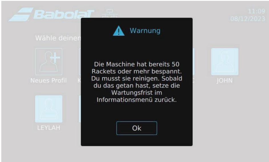
Nachdem die Wartung durchgeführt wurde (siehe Kapitel 10), öffnen Sie das Menü „Info“ und wählen „Raz maintenance“ (Wartung zurücksetzen), um den Zähler auf 0 zurückzusetzen.
