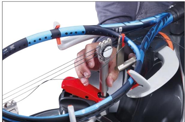
**Legen Sie das Seil zwischen die Klemmbacken, senken Sie den Klemmhebel und üben Sie Druck auf den Verriegelungshebel aus, um den Klemmhalter zu verriegeln.**
