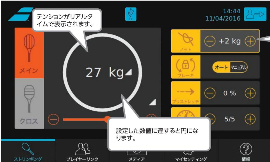
ノット・オーバーテンションは、+/-で設定します。アイコンを押して、ON/OFFを切り替えます。このボックスが黄色い枠のライトグレーの時に、オーバーテンションがかかります。次のプリング操作後、自動的にOFFになります。
